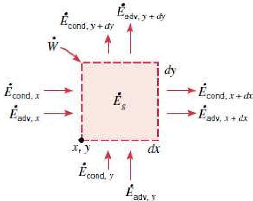
Volume de controle diferencial ( $dx.dy.1$ ) para a conservação de energia em um escoamento bidimensional de um fluido viscoso com transferência de calor.
