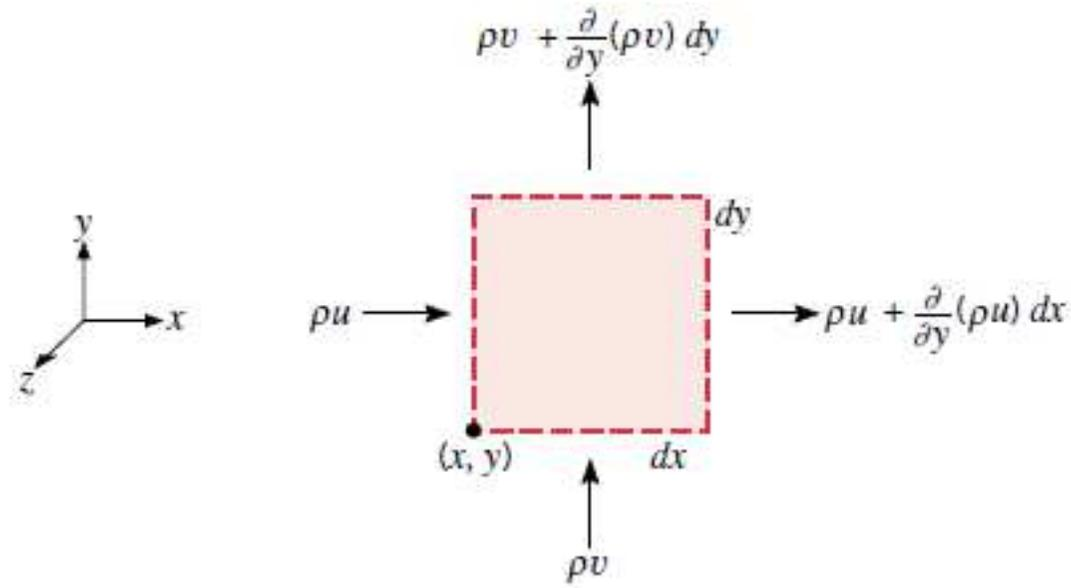
Volume de controle diferencial ( $dx \cdot dy \cdot 1$ ) para a conservação de massa em um escoamento bidimensional de um fluido viscoso
