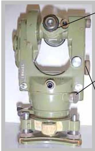
ESTANDO AGORA O TEODOLITO ZERADO E DIRECIONADO NO PRIMEIRO PONTO, SOLTA-SE O PARAFUSO DO MOVIMENTO PARTICULAR DIRECIONANDO-SE A LUNETA ATÉ O SEGUNDO PONTO, ONDE SE DESEJA OBTER O ÂNGULO, CENTRALIZANDO O FIO VERTICAL PERFEITAMENTE COM A BALIZA.
